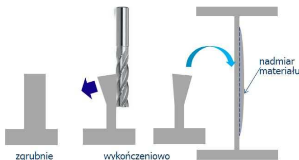
Rys. 4. Problemy przy obróbce cienkiego żebra Fig. 4. Problems with the machining of thin rib
