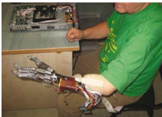
Rys. 2. Zamontowana proteza ręki na kikucie z systemem sterowania.
